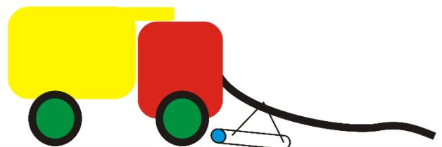
Lässt die Spannung nach, dann senkt sich das Seil mit dem Stab zu Boden
